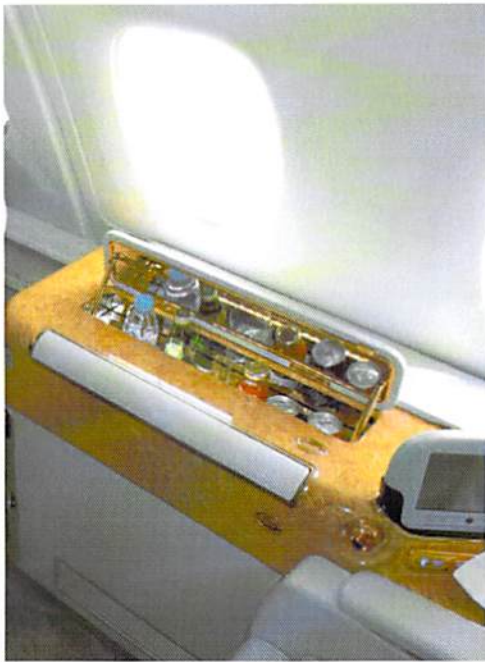
Blick in die Outboard-Kabine der Emirates A380 First-Class-Suite Upper-Deck; zu sehen sind Vanity-Table & Credenza mit DFC-Beschichtung. Bild: DFC; Georg Noak
